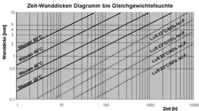
Polyamide ändern ihre Glasübergangstemperatur in Abhängigkeit der Feuchteaufnahme und damit einige mechanische Eigenschaften. Die Feuchteaufnahme ist abhängig von den Lagerungsbedingungen, der Zeit und der Wanddicke. Das untenstehende Diagramm soll Anhaltswerte für die Feuchteaufnahme geben. Für beschleunigte Konditionierverfahren stehen Ihnen die Spezialisten der PENTAC Polymer GmbH für Auskünfte zur Verfügung.
